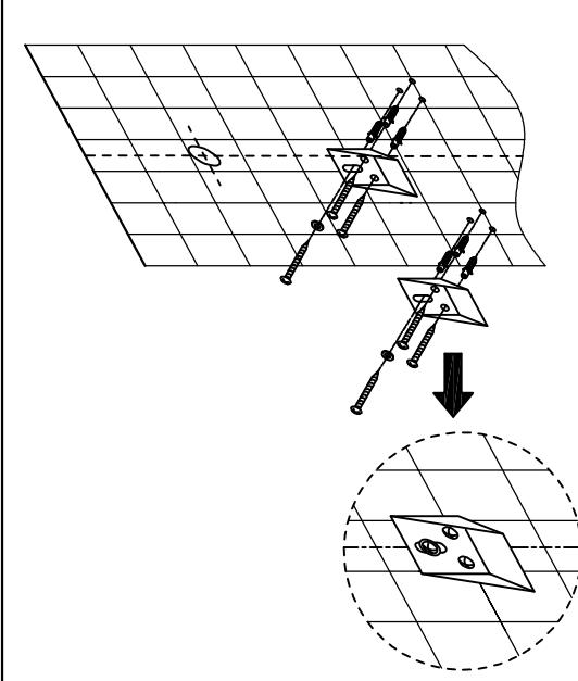
3. Lắp đặt bích nối tường / Install the wall flange
