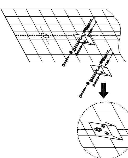
3. Lắp đặt bích nối tường./ Install the wall flange.
